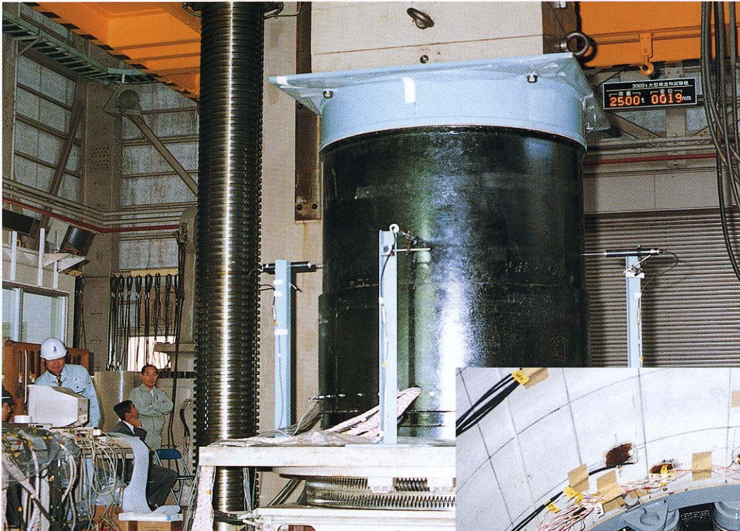
中押管の性能実験（呼び径1200） 軸力 P=2500 tf
