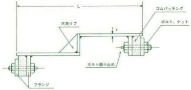
※コンクリート管×鋼管、コンクリート管×鋳鉄管、塩ビ管×コンクリート管等も可能です。 (相手管の外径にあわせて製作いたします。)
