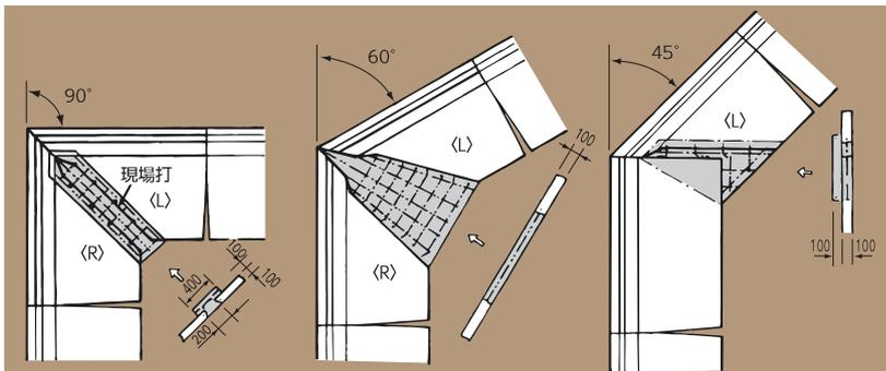
注) 現場打部は、埋込インサート(M12)への差し筋を利用してD13×200mmピッチ程度の配筋とする。
