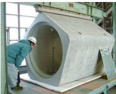
ペンタ・ボックスの曲げ試験
