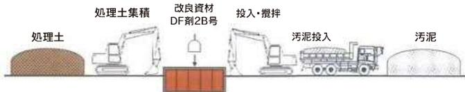
産業廃棄物(汚泥)を、場内に設置した自走式改良機、または鋼製改良槽において中間処理+養生後、コーン指数測定試験及び土壌環境基準分析(溶出・含有試験)を実施 ▶ 場内再利用
