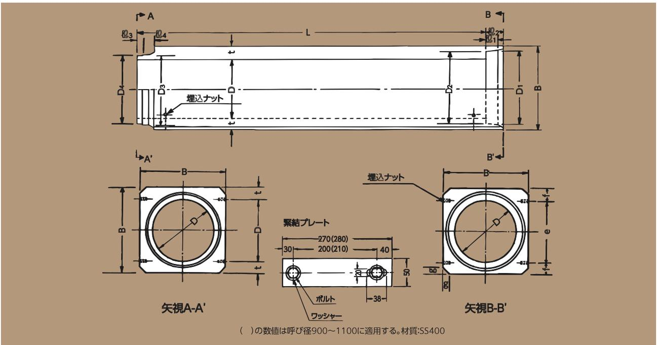
注) 継手部はヒューム管B形と同じ形状寸法でゴム輪を用いて接合します。
