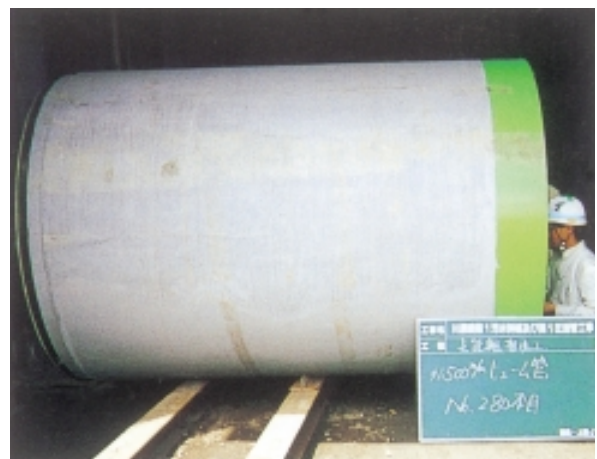
防菌剤入埋込カラー付推進管(ビックリート)φ1500×2.43 (A-2)
